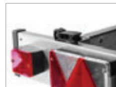
Ljusramp med quick-release-fästen
