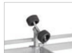
Dubbla multijusterbara X-line-sidorullar fram
