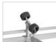
Dubbla multijusterbara X-line-sidorullar fram
