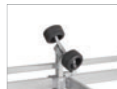
Dubbla multijusterbara X-line-sidorullar fram
