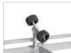
Dubbla multjusterbara X-line-sidorullar fram
