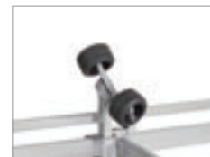
Dubbla multijusterbara X-line-sidorullar fram
